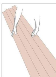
Simulasikan lonjoran **DUMA® PANEL** di permukaan yang rata, untuk menentukan urutan pemasangan.
