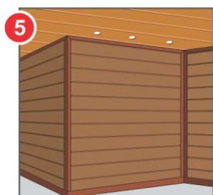
Pasang Lis Profil dengan lem PVC & **paku tembak** setelah seluruh area plafon atau dinding tertutup dengan **DUMA® PANEL**.
